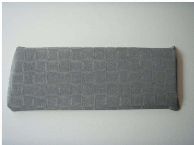
Der Grauton entsteht durch Beimischung von Pigmenten.
