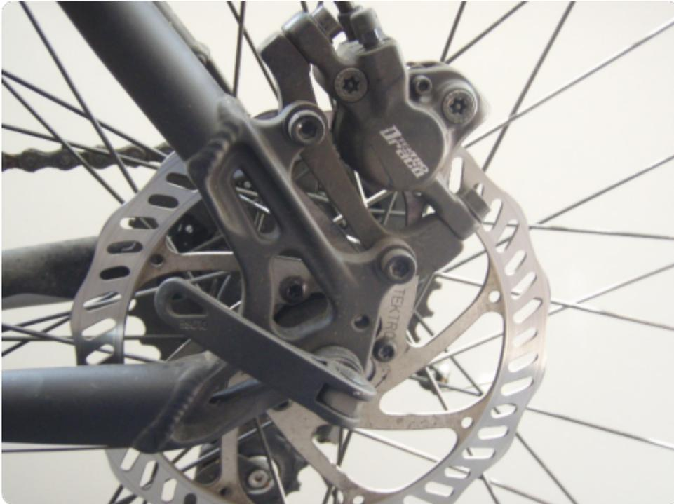
🚲35 Hydraulische Scheibenbremse.
