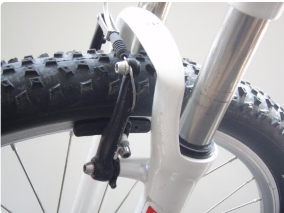
🚲34 Mechanische Felgenbremse, hier als V-Brake.
