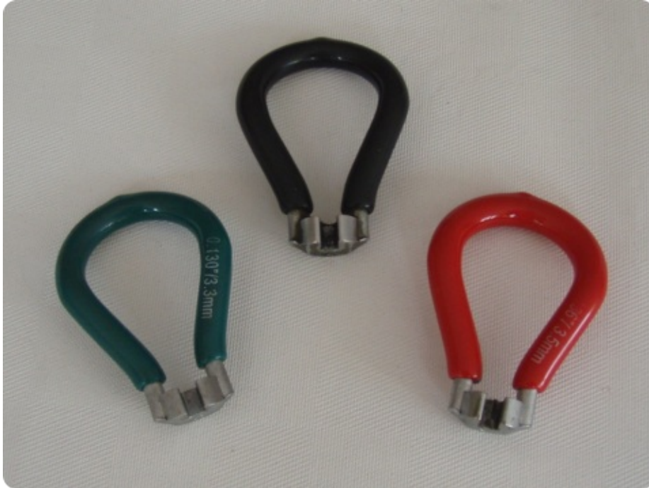
FT31: Nipperspanner in grün 3,3 mm, schwarz 3,2 mm und rot 3,5 mm.
